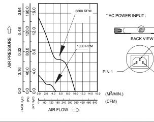
) 🗐 FTA0102AA PIN ASSIGNMENT BACKPLANE SCOKET C14 SK-1015 -PIN 3 PIN 1 LINE(L) PIN 2 NATURE(N) PIN 3 GROUND(.+.) -PIN 2
